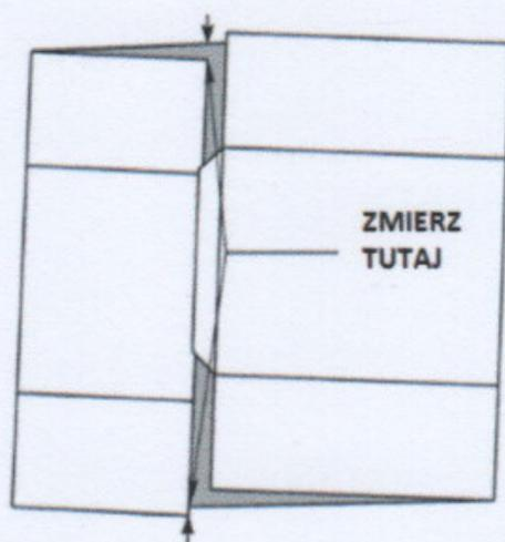
**6. Déviation de la largeur de la fente au niveau du collage (c) : -/-**
